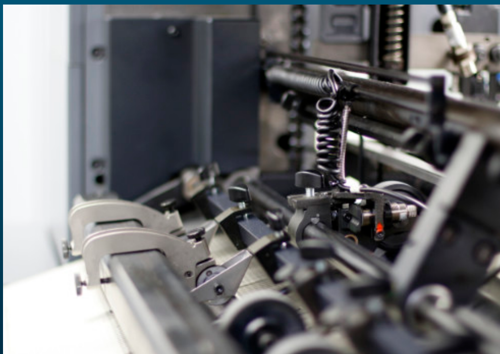
Ausrichten der einzelnen Druckwerke mit einer Montagebrücke
