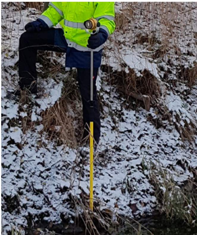
Aufhalten der Gewässerkannte mit Rundprisma und Prismenstab an der Lossa
