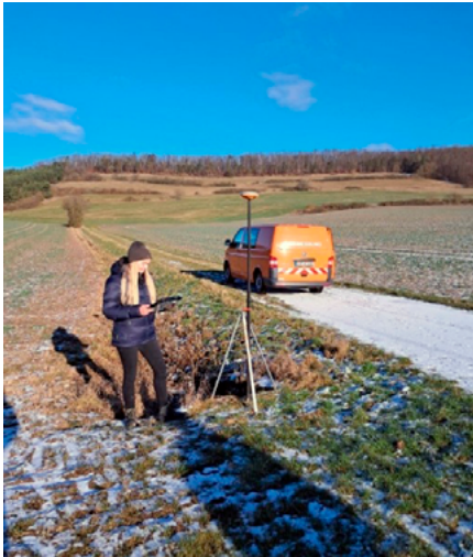
Methode GNSS-Empfänger mit Korrekturdaten
